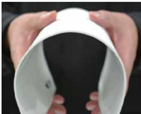
Эластомерный материал Террако сохраняет свою эластичность при -20^{\circ}\text{C}
