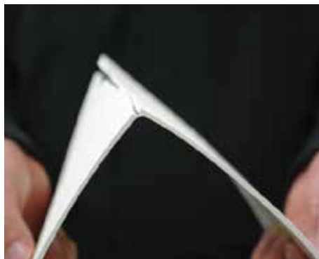
Обычный эластомерный материал при -20^{\circ}\text{C} теряет свою эластичность
