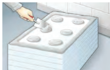
Ленточно – точечный способ «валик-точка»
